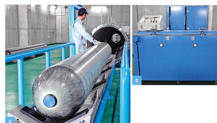
a/膨張量測定装置 開 b/恒温環境試験装置
