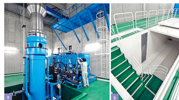
a/500L級液圧サイクル試験装置 b/試験ビット
