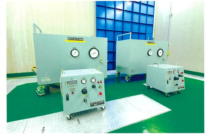
移動式昇圧装置 移動式のブースターを用意。試験内容により各試験室で利用できます。 圧力 110MPaG 流量 7m³/h
