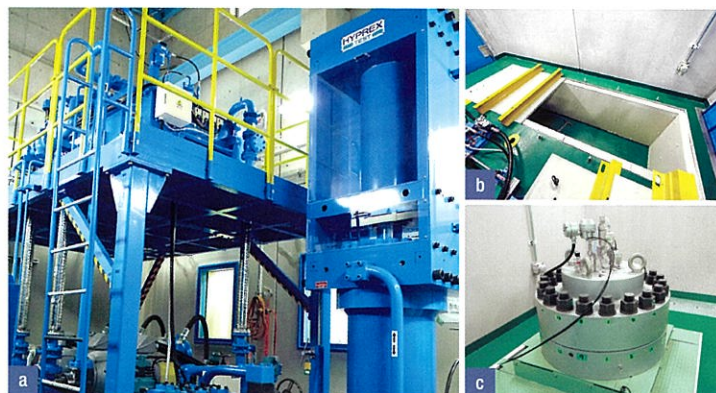
a/300L級水圧サイクル試験装置 b/試験ピット c/外水圧試験装置加圧容器部(水槽部)
