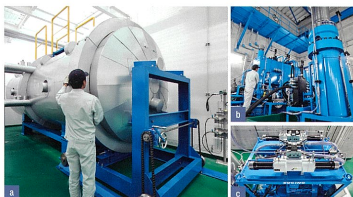
a/大型温調カバー b/500L級液圧サイクル試験装置 c/高温クリープ試験装置
